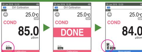
5. Repita os passos de 1 a 4 para realizar a calibração com a(s) solução(ões) padrão seguinte(s).
